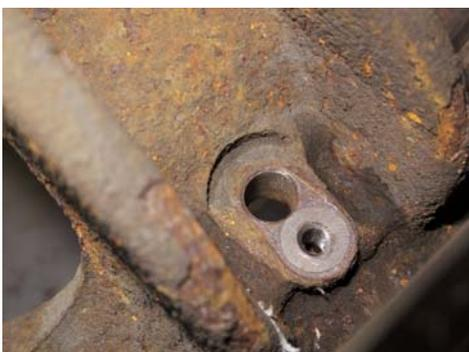
Avant le montage d'un nouveau capteur de vitesse de roue ABS, il faut nettoyer en profondeur l'alésage de réception et le reposer à la cote nominale. L'alésoir ATE est l'outil idéal à cet effet.
