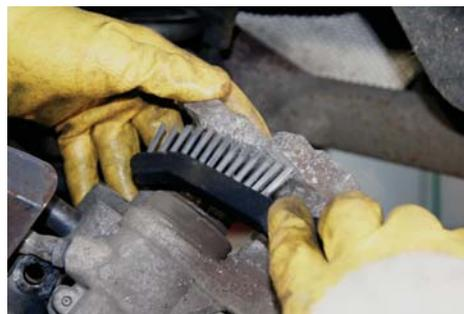
La brosse métallique spéciale ATE sert à enlever les légères impuretés sur les faces de guidage des plaquettes des étriers et supports de freins.
