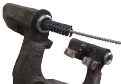
Des goujons de guidage lubrifiés sont utilisés pour l'introduction des étriers flottants "LUCAS". Ceux-ci sont rendus étanches avec des soufflets. En cas de soufflets endommagés, les douilles de guidage sur le support d'étrier de freins se corrodent. Par conséquent, il en résulte des difficultés pour le guidage de l'étrier de freins et d'autres problèmes de freinage.
