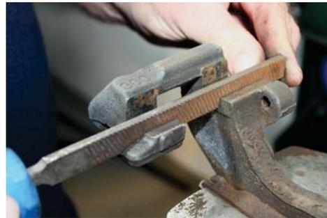
La lime pour rainure d'étrier de frein d'ATE permet de mettre le métal à nu en limant les faces de guidage des plaquettes sur les étriers de frein et les supports de freins. La taille unilatérale permet d'éviter une détérioration du cache-poussière. Les dents grossières spéciales autorisent un travail propre et rapide.
