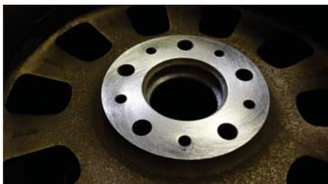
Le kit de nettoyage pour rebords de jante d'ATE est un outil idéal pour un nettoyage de la surface d'appui des jantes à la fois rapide, sûr et économique. Avant de monter la jante, il est conseillé de nettoyer la surface d'appui de la jante avec le disque de frein. Ce n'est qu'ainsi qu'il est possible d'observer les tolérances strictes entre la jante et le disque de frein.
