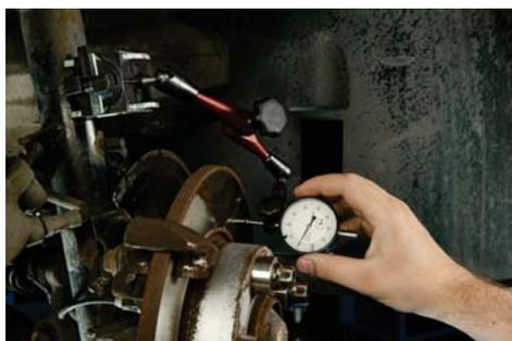
Les disques d'écartement ATE permettent de fixer rapidement et de manière sûre le disque de frein sur le moyeu de roue. À l'aide des boulons de roue ou des écrous jusqu'à M14 avec bille ou cône d'origine, le disque de frein est fixé de manière professionnelle au moyeu, et son battement axial et radial est prêt à être mesuré.
