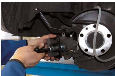
Sur les étriers à griffe avec frein à main intégré (étriers combinés), le piston ne doit pas être repoussé, sinon le mécanisme de rattrapage du jeu dans l'étrier est détruit. Il faut faire pivoter et presser les pistons maintes fois. Ceci est rendu possible par le jeu d'outils de refoulement des pistons ATE. Il convient pour tous les véhicules courants grâce à ses 9 adaptateurs interchangeables. Il permet aussi de repousser des étriers à griffe normaux.
