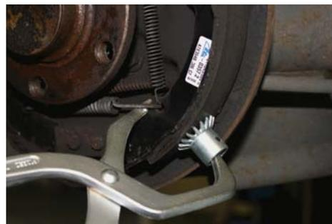
La pince (moyenne) pour ressort de frein ATE permet de démonter et de monter très simplement et sûrement les ressorts de rappel des mâchoires de freins sur les freins à tambours. La petite coupelle d'appui articulée s'appuie sûrement, même sur l'étroite surface des garnitures de freins, grâce à sept crampons pointus. Le crochet autorise un accrochage du ressort.
