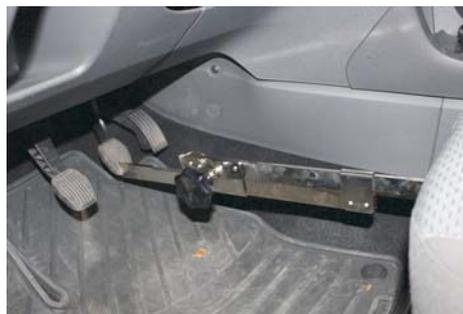
Pour les contrôles d'étanchéité sur les systèmes de freinage hydraulique, il est nécessaire de maintenir pendant une durée prolongée une pression constante sur la pédale de frein. Une pression constante sur la pédale de frein est aussi requise pour le contrôle et le réglage des correcteurs et des limiteurs de la force de freinage. On peut la réaliser de façon idéale avec le système de blocage de la pédale ATE.
