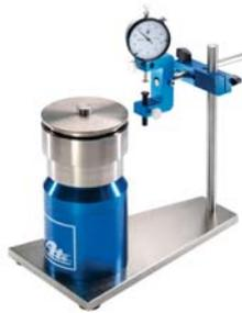
À l'aide du dispositif de mesure des disques de frein d'ATE, il est désormais possible de mesurer avec précision le battement axial (voile latéral) et les différences d'épaisseur des disques de frein démontés jusqu'à un diamètre maximal de 360 mm.
