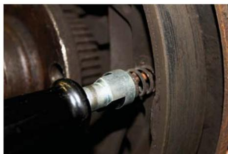
L'outil de montage des ressorts ATE sert au démontage et au montage sûr et sans problème des coupelles de maintien des ressorts de retenue des mâchoires de freins. Mise en place sûre des petites et moyennes coupelles de ressorts des ressorts de retenue des mâchoires de freins grâce à deux entonnoirs de mise en place de différentes tailles.
