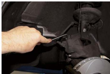
Le jeu de clés de purge d'air spéciales d'ATE est composé de clés à anneaux spéciales contrecoudées. Grâce à leur coude court et leur court long, elles permettent d'ouvrir et de fermer facilement les vannes de purge d'air sans démonter les roues. Les clés de purge d'air spéciales d'ATE sont du type à 6 pans. Ceci permet d'assurer une bonne prise sur les vannes de purge d'air sans les détériorer.
