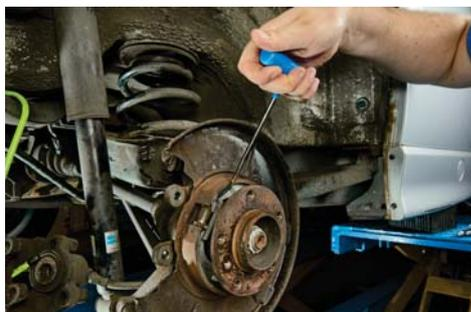
Le crochet pour ressort ATE constitue l'outil idéal pour démonter et monter sans problème les ressorts de retenue des plaquettes de freins.
