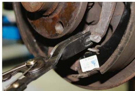
La pince à ressort du câble de frein à main ATE permet d'accrocher facilement et sûrement le câble du frein à main sur le levier des mâchoires de freins sur les freins à tambour. Elle est surtout une précieuse aide pour le montage du Top Kit ATE.
