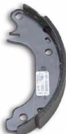
Original ATE beschichtete Trommelbremsbacke nach 48 h Salzsprühstest
