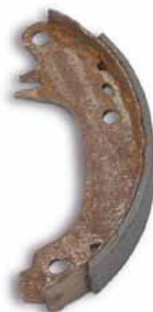
Unbeschichtete Trommelbremsbacke nach 48 h Salzsprühstest
